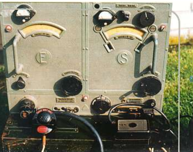
Duitse zend/ontvanger uit W.O.II. Type Torn. Fu b1/24b-201. Met seinsleutel en microfoon met opschrift "Feind hört mit"
